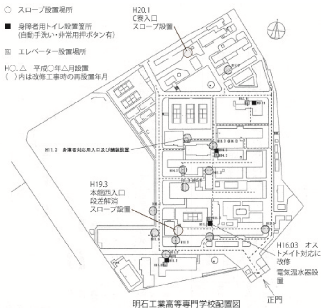
図6-6-1 キャンパスにおけるスロープ・身障者用トイレ・エレベーターの設置 (平成17年度までの整備箇所を含んだ図を示す)
