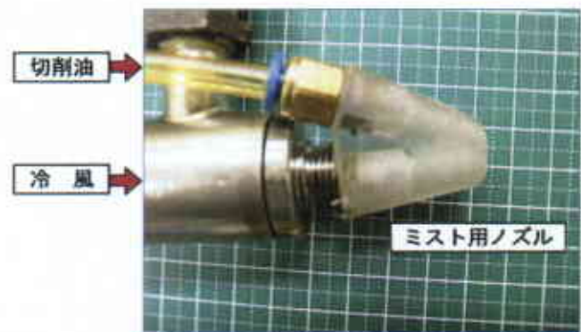
図 5 冷風ミスト加工用のノズル
