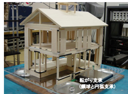
写真 3 転がり免震模型全景
