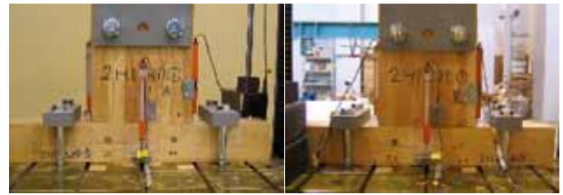
図 2 試験機との取り付けおよび変位計位置
