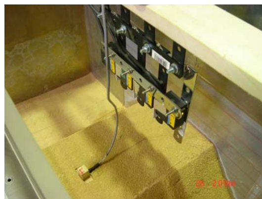
(a) 盛土天端での変位および加速度の計測
