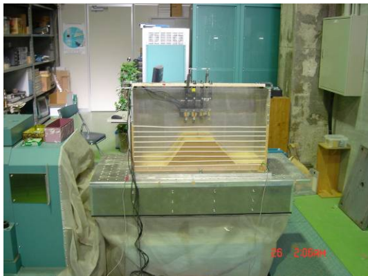
(a) 振動台実験装置外観
