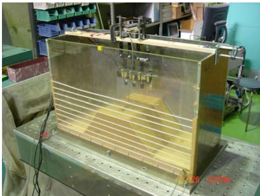
(b) 土槽および模型盛土
