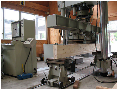
写真 1 試験機、試験体の設置状況
