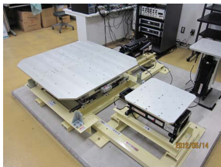
写真2 2方向地震波振動台(改良後)
