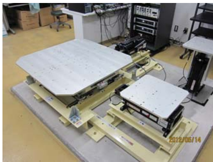
写真 1 2軸地震波振動台(改良前)
