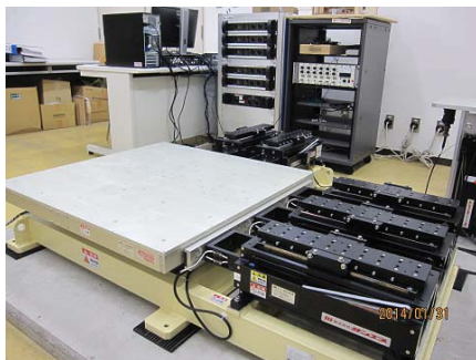
写真 2 2軸地震波振動台(改良後)
