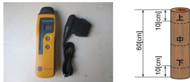
図5 サーベイマスター水分計及び測定位置
