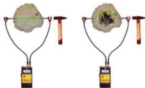
図7 応力波の伝搬経路のイメージ
