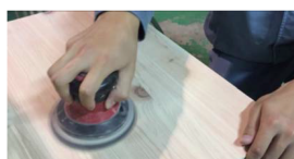
丸紀木材工業様での作業 (その1) 磨る部分の丸みを削り出している
