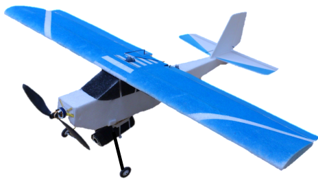
ドライブレコーダーとRC 模型飛行機を利用した簡易情報収集装置 (明石)
