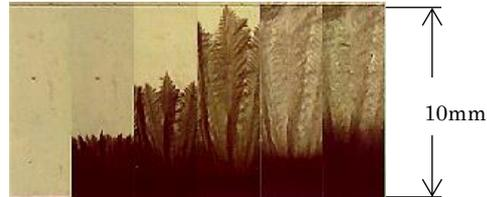
図2 凝固の様相(2%塩化ナトリウム水溶液)
