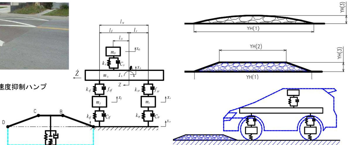
図3. 自動車速度抑制可調式ハンプ
