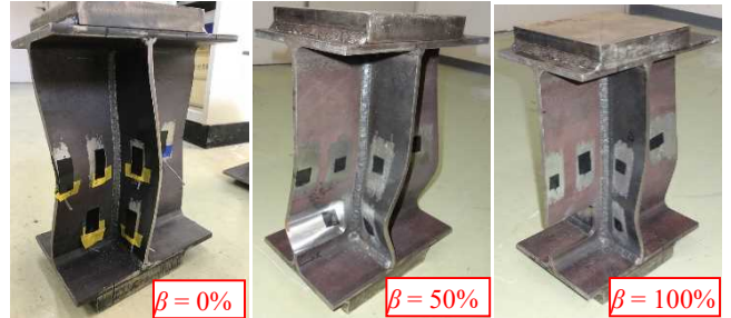
圧縮実験後の種々の板厚欠損率 \beta を持つ鋼桁支点部模型 ( \beta = 50, 100\% の模型は、板厚欠損部を含む断面に生ずる圧縮応力が大きくなるため、断面欠損部に顕著な面外変形を生ずる傾向がみられる)
